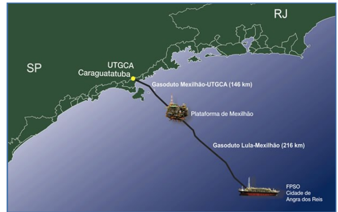
Figura 1. Ilustração do Gasoduto Lula-Mexilhão instalado no Bloco B-S-11, que liga a FPSO Cidade de Angra dos Reis no Campo de Lula à Plataforma de Mexilhão, com capacidade de escoar até 10 MMm³/d, operado pela Petrobras com 65% de participação na sociedade com a BG Group (25%) e Galp Energia (10%). (Fonte: Petrobras)
