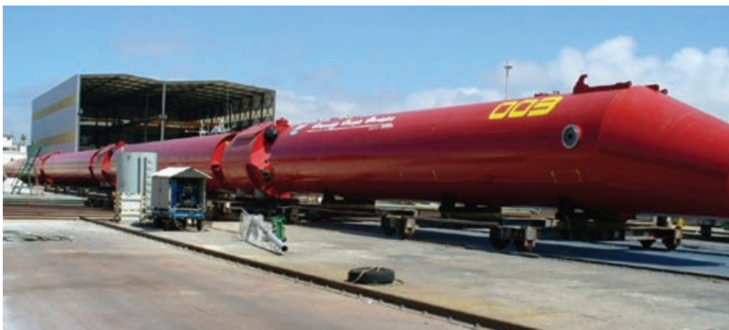
Figura 23 - Pelamis: montagem da instalação em Póvoa do Varzim
