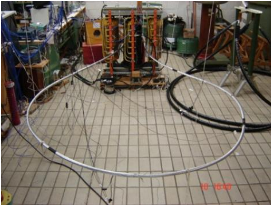
Figura 8: Configuração experimental dos cabos ensaiados
