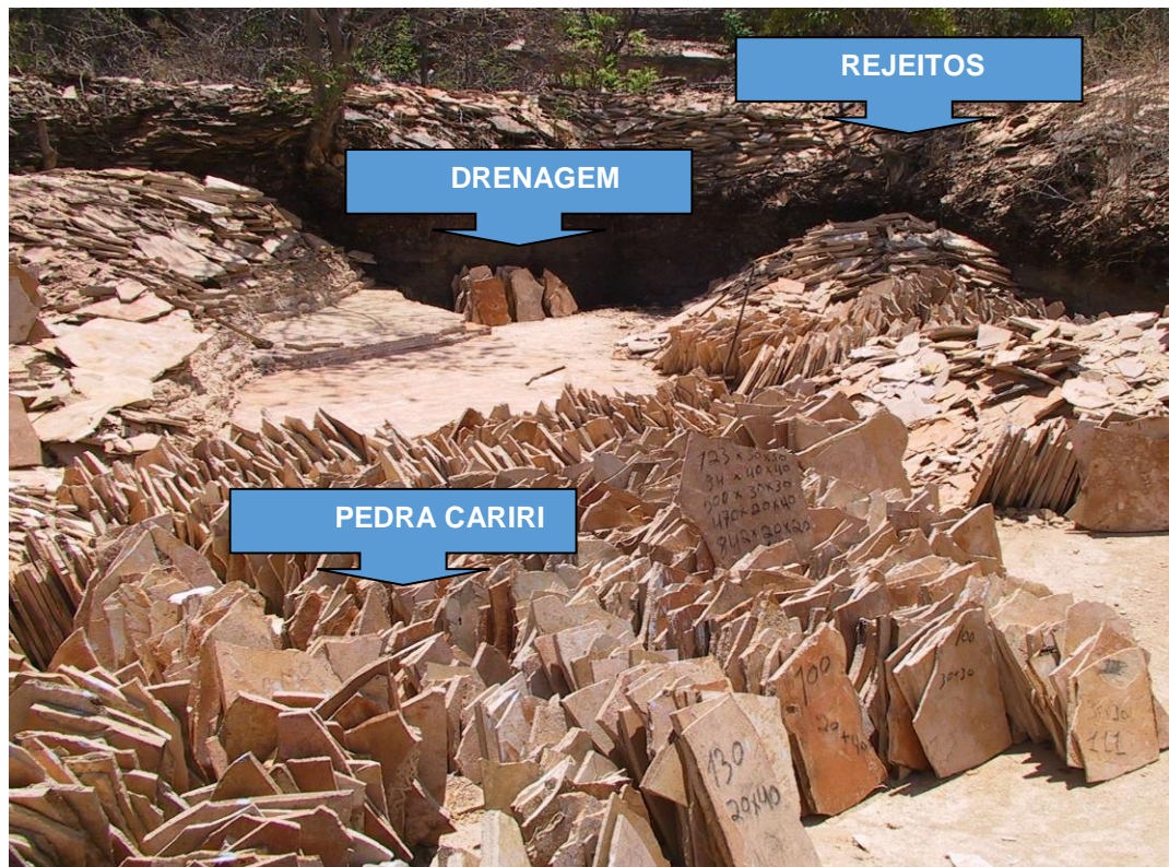
Figura 2. Extração rudimentar de calcário laminado, “Pedra Cariri”, aproveitando as drenagens com detalhes da drenagem e da disposição desordenada dos rejeitos. Fonte Castro 2004.
