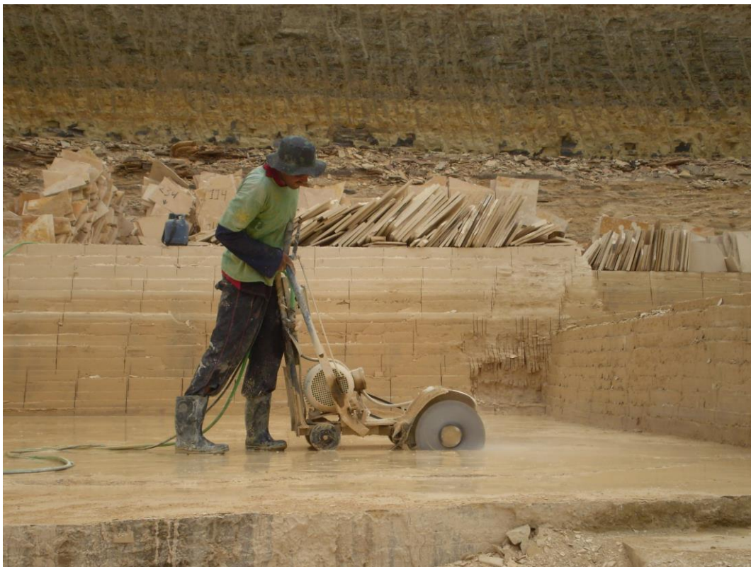
Figura 8. Vista de frente de lavra mecanizada com energia e abastecimento d'água para possibilitar o corte das placas. Parahyba 2008.
