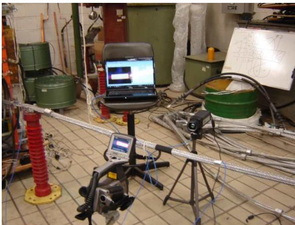
Figura 10: Medições de temperatura com câmeras de termo visão.
