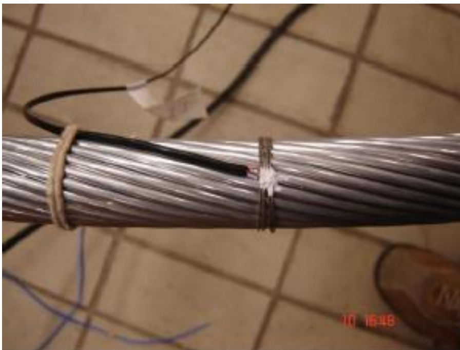
Figura 9: Fixação do termopar na superfície externa do cabo
