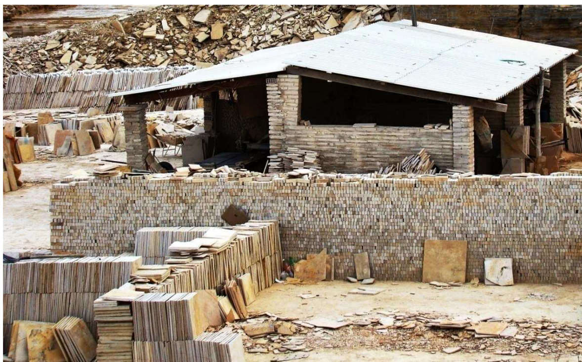
Figura 6. Unidade de beneficiamento de Pedra Cariri com estoque de materiais produzidos e, ao fundo, pilha de rejeito do beneficiamento. Fonte. Mendes Filho (2009)
