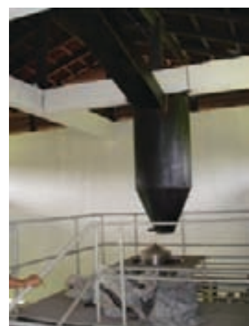
Figura 11.20 – A: Depósito de secagem de biomassa com cobertura móvel para proteger da chuva. B: Duto de ligação do silo com o gasificador.
