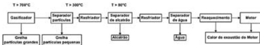
Figura 7.8 –Relação esquemática de temperatura do gás para remoção de contaminante
