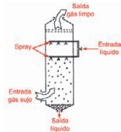
Figura 7.12 – Separador do tipo Spray
