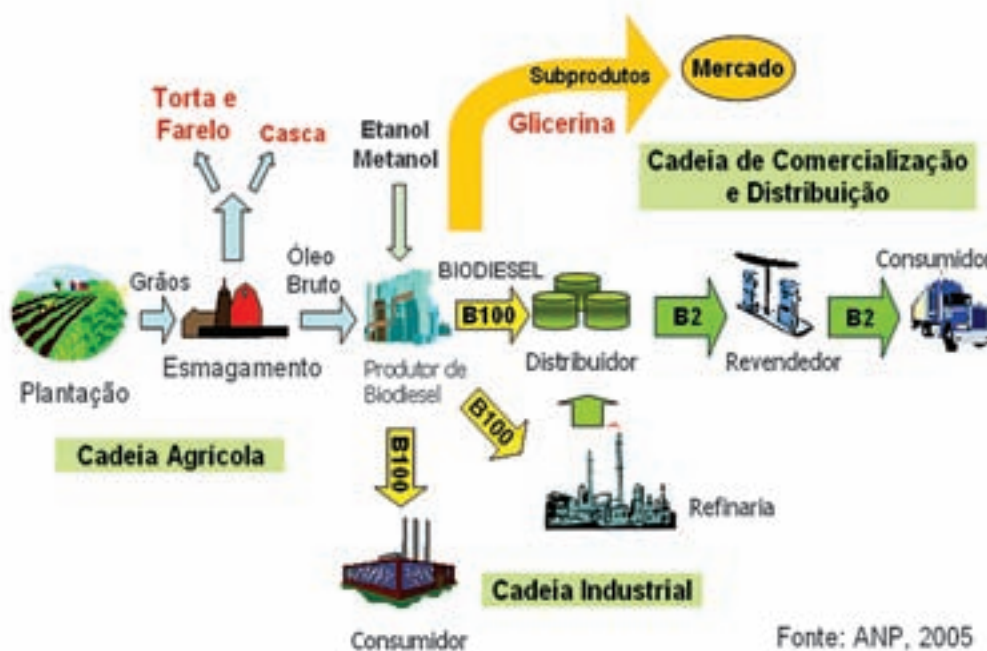
Figura 6.1 – Cadeia de produção do biodiesel.
