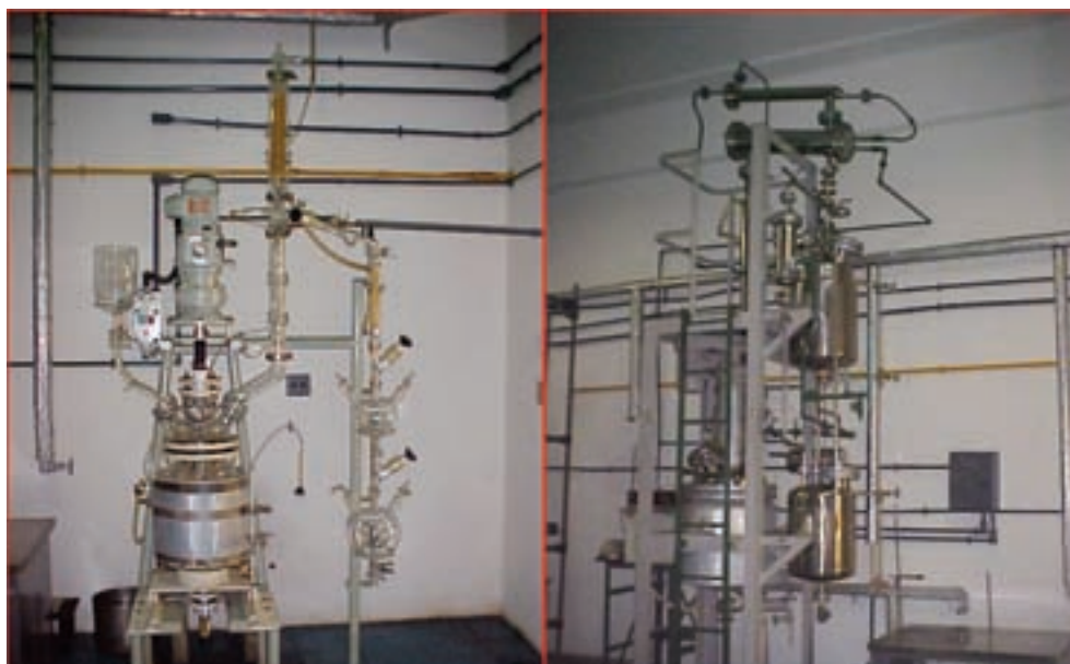
Figura 5.15 – Reatores pilotos com capacidades de 20 L e 50 L.
