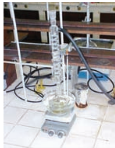
Figura 5.12 – Aparelhagem de refluxo usada nas reações homogêneas.
