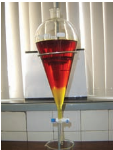
Figura 5.13 – Lavagem do biodiesel com solução de ácido acético; formação de três fases.
