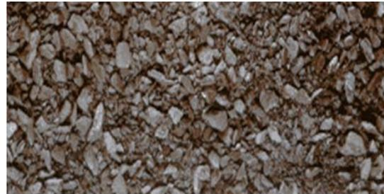
0,15mm < Sinter Feed < 6,3mm
