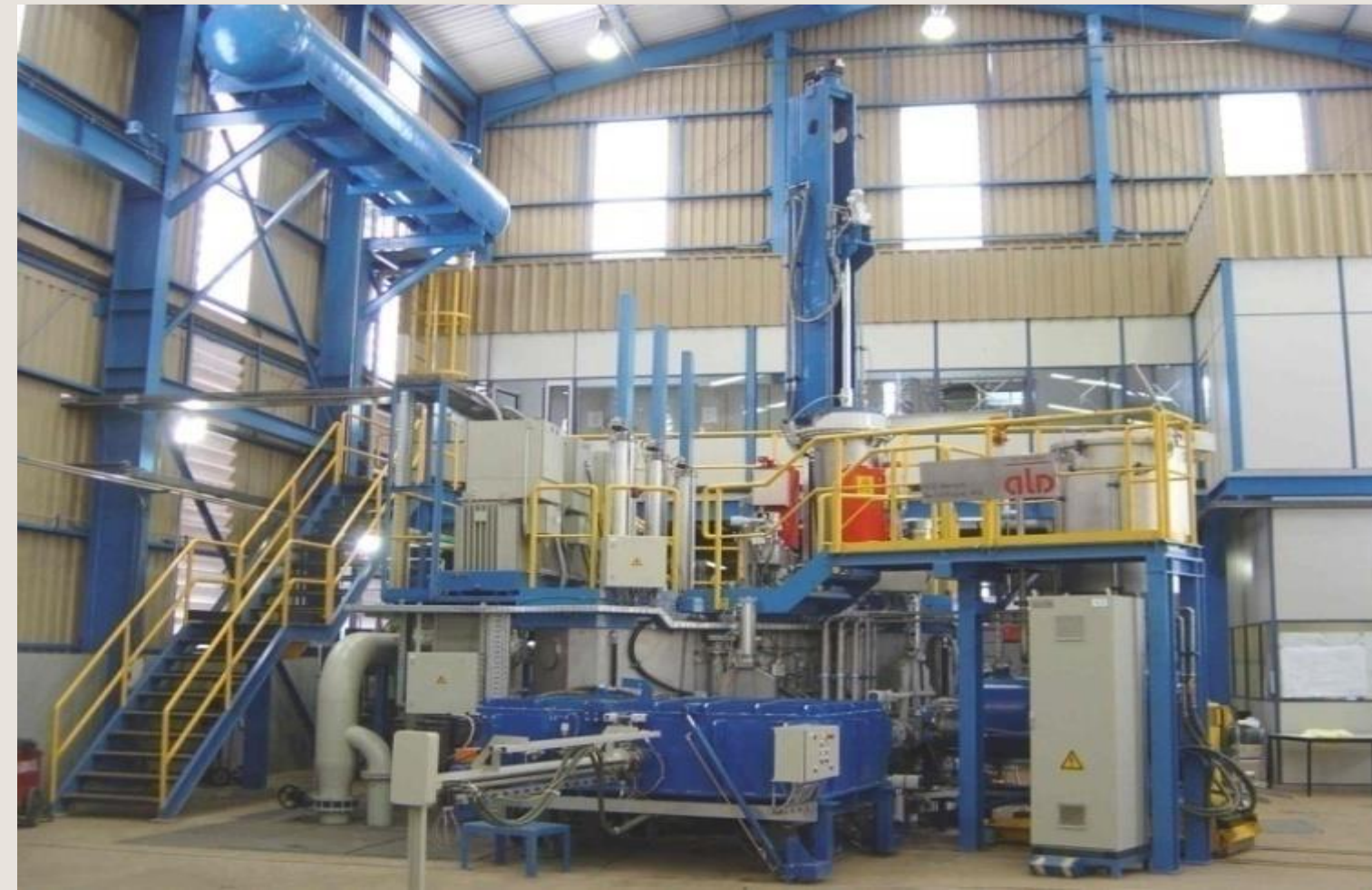
Refino do ATR em fornos de Feixes de Elétrons.
