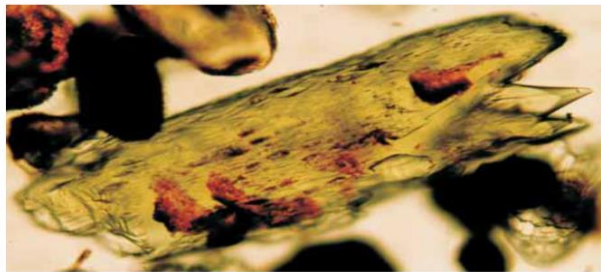
Figura 5. Cristal de diopsídio (piroxênio), mineral comum dentro os pesados nos sedimentos, exibindo capas de argilomineral com óxido de ferro e feições de dissolução.
