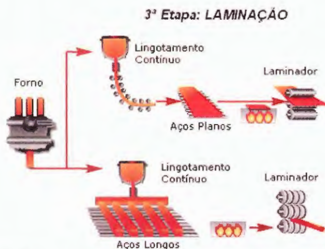
Figura 5 – Fluxograma de siderurgia de semi-integrada tipo mini-mill
