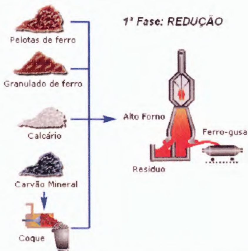
Figura 4 – Fluxograma de um alto forno siderúrgico de redução de minério Fonte: PILLA Corretora
