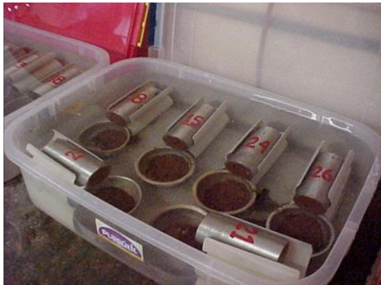
Figura 22. Ensaio de Perda de Massa por Imersão
