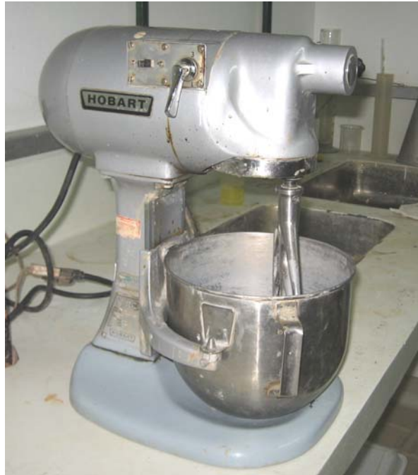
Figura 36. Argamassadeira planetária utilizada na pesquisa
