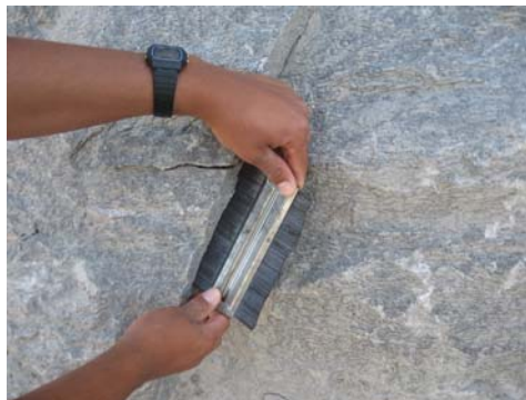
Figura 14. Medição da rugosidade com o perfilômetro
