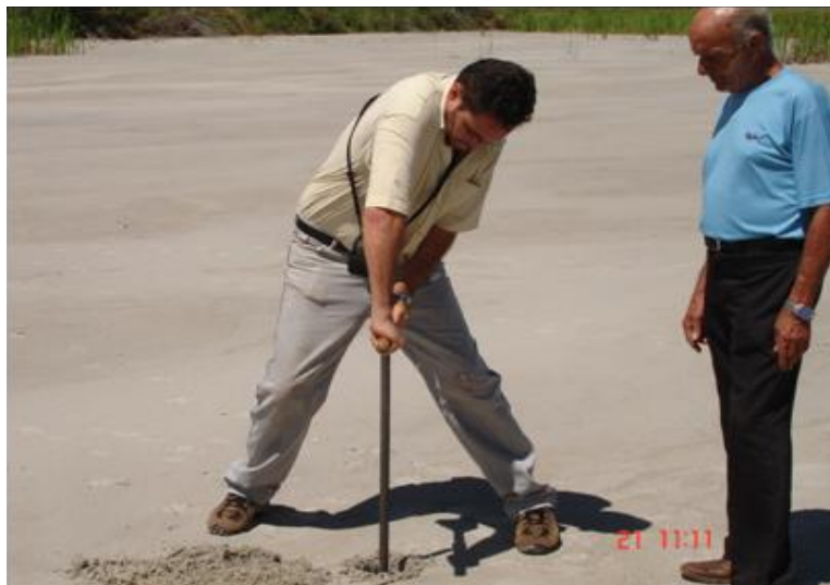
Figura 19. Coleta de amostra do rejeito, realizado dentro da barragem
