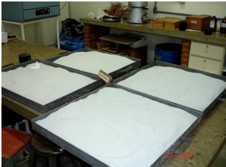
Figura 21. Secagem do rejeito
