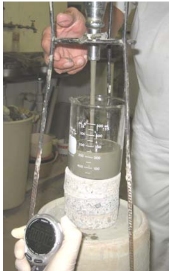
Figura 37. Determinação do tempo de escoamento do Cone de Marsh para pastas
