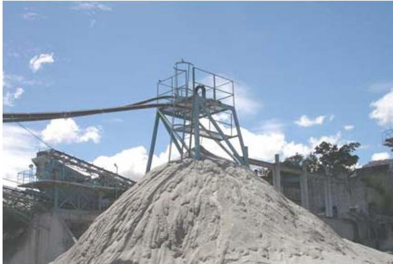
Figura 18. Hidro-ciclone e pilha de resíduo da Pedreira 1
