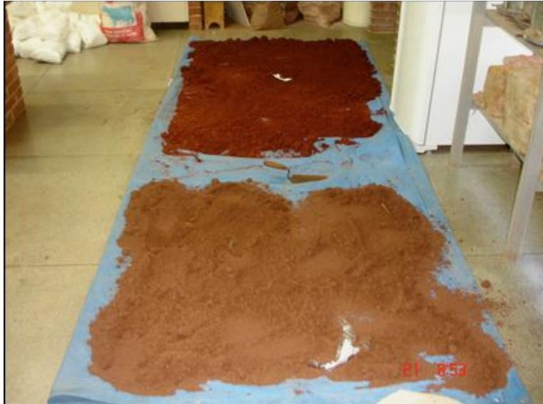
Figura 20. Secagem das amostras de solos no laboratório
