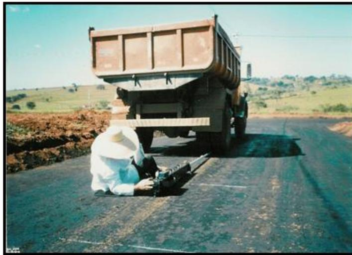
Figura 28. Ensaio de Viga Benkelman
