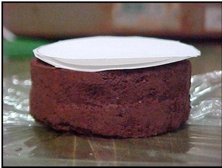
Figura 25. Ensaio de sucção
