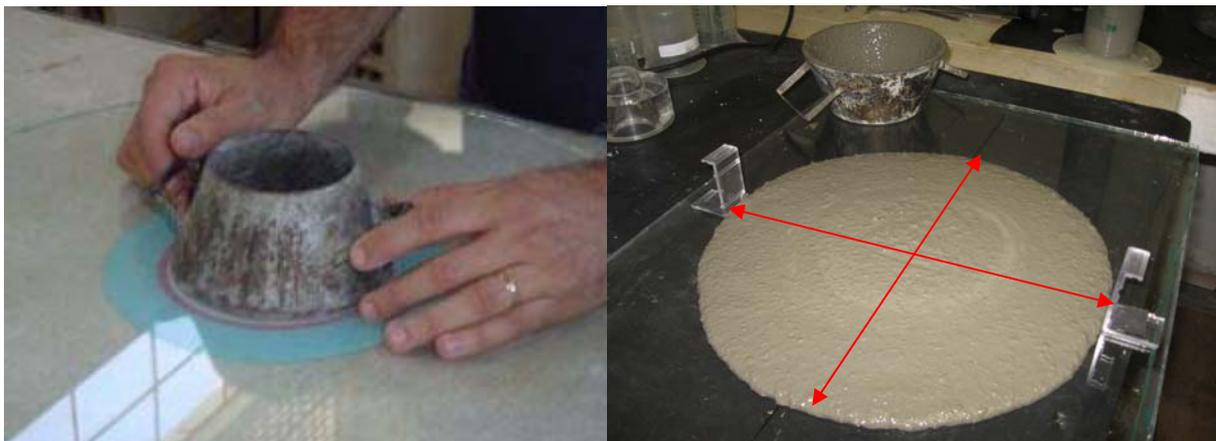
Figura 38. Ensaio com tronco cone em argamassas
