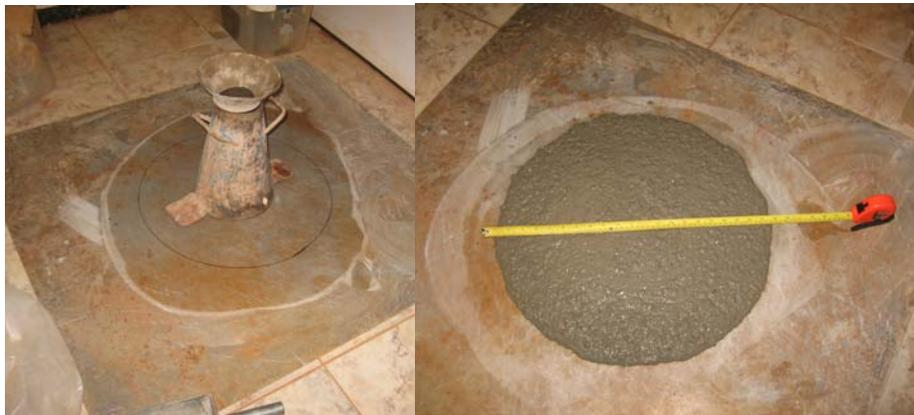
Figura 39. Ensaio de espalhamento
