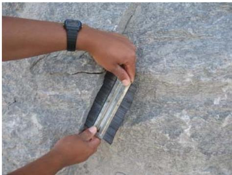
Figura 14. Medição da rugosidade com o perfilômetro
