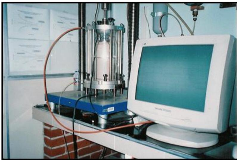
Figura 26. Ensaio de módulo de resiliência
