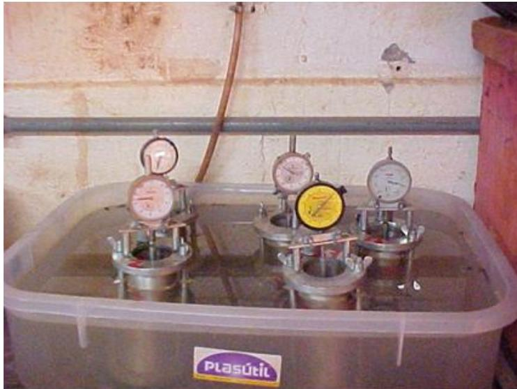
Figura 23. Ensaio de MINI-CBR
