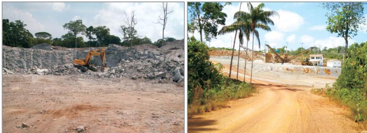
**Figura 4.28** - Frente de lavra (esquerda) e planta de beneficiamento de brita (direita) da empresa Gran Amapá do Brasil Importação e Exportação Ltda. - Ferreira Gomes. Fotos: IEPA/SEICOM.
