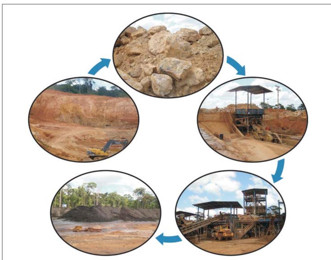
**Figura 4.12** - Da extração ao beneficiamento do minério de cromita pela Mineração Vila nova. Fotos: IEPA/SEICOM.
