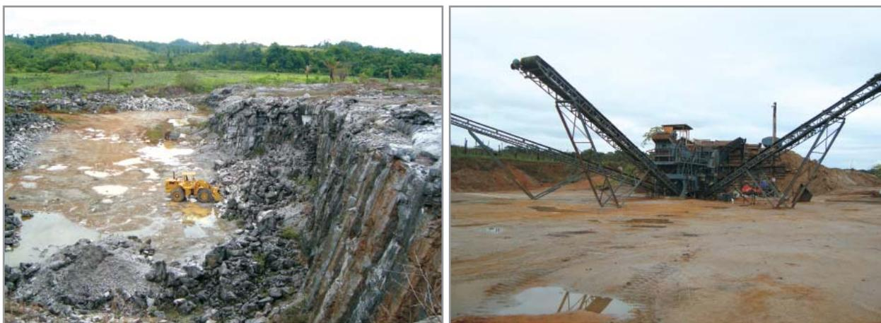
**Figura 4.32** - Jazida de extração de brita no Oiapoque da EGESA/CMT. À direita a unidade de britagem.
