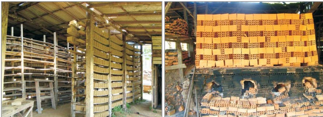
**Figura 4.44** - Problemas na produção oleiro-cerâmica. (A) Secagem natural. (B) Forno pouco eficiente tipo caieira. Fotos: IEPA/SEICOM.
