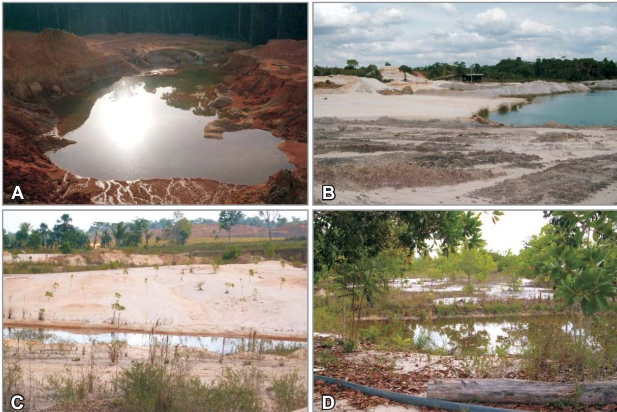
**Figura 4.24** - (A) Área de extração de seixo abandonada e degradada sem qualquer procedimento de recuperação (CLAUDSSOM PEDROSO ME). (B) Mostra uma lavra parcialmente paralisaada e pouco recuperada (HA Gurgel - ME). (C) Plantio de mudas sem recuperação do solo (Fabrício V. Lessa e Cia.). (D) Área de extração com recuperação incipiente, com uso de plantas exóticas (*Acácia mangiús*) e sem recuperação edáfica.
