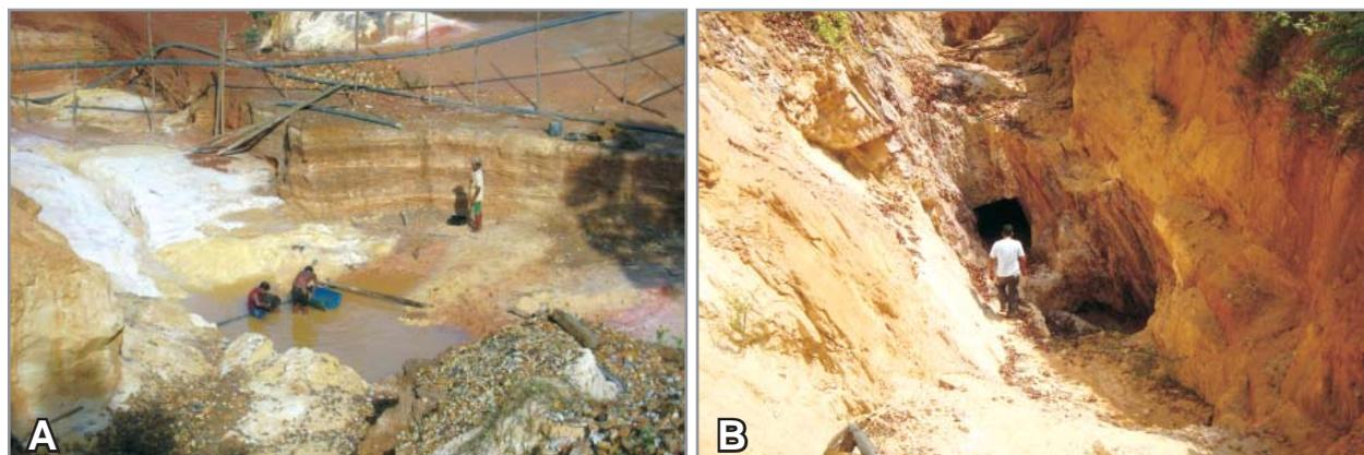
**Figura 4.36** - Frentes de trabalho do garimpo do gaivota: (A) Repassagem de material aluvionar já trabalhado anteriormente, (B) frente de lavra com abertura de galeria.
