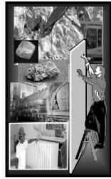
O gesso se origina da calcinação da gipsita. A gipsita é um mineral abundantemente na natureza e existem jazidas espalhadas por muitos países do mundo. Quimicamente a gipsita é um sulfato de cálcio hidratado cuja fórmula é  $\text{CaSO}_4 \cdot 2\text{H}_2\text{O}$ , e tem a composição estequiométrica média de 32,5% de CaO, 46,6% de  $\text{SO}_3$  e 20,9% de  $\text{H}_2\text{O}$ .
