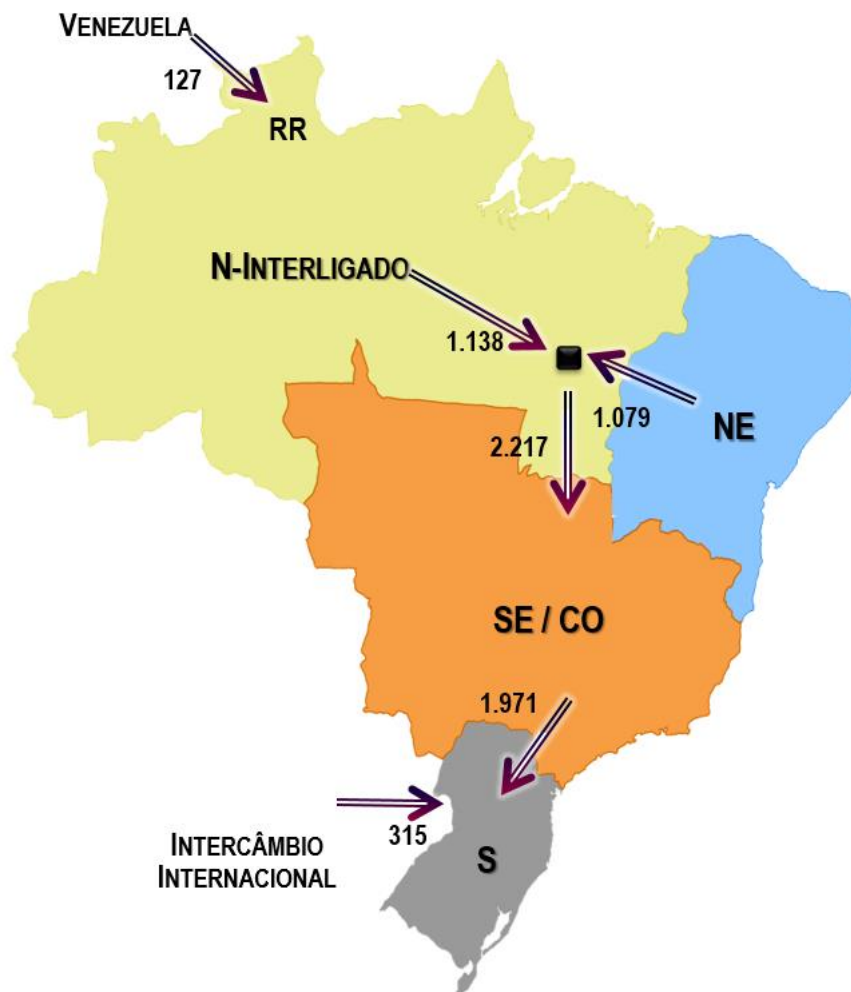
Figura 10. Principais intercâmbios de energia (MWmédios).
