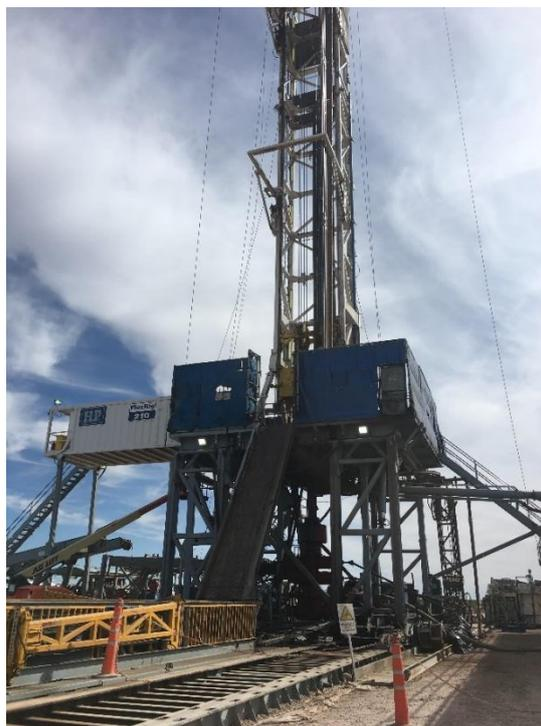
**Figura 2:** Sonda de perfuração de poços com *topdrive*.
