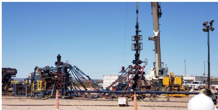
**Figura 4:** Equipamentos de cabeça de poço durante a operação de fraturamento hidráulico.
