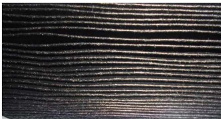
Figura 6 – Ampliação do elemento filtrante
