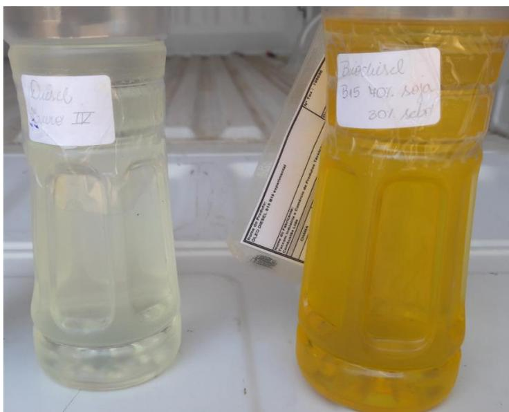
Figura 05: Amostras de diesel Euro IV e diesel S10 B15 70% soja / 30% sebo a 0°C após dois dias
