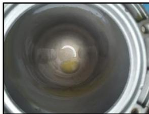
Figura 5: Aspecto do corpo do elemento filtrante do filtro de combustível após o teste de armazenamento de combustível por 30 dias.
