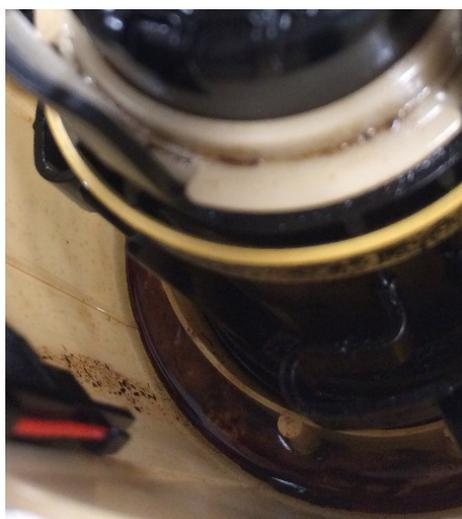
Figura 19 - Resíduo interno na bomba de combustível
