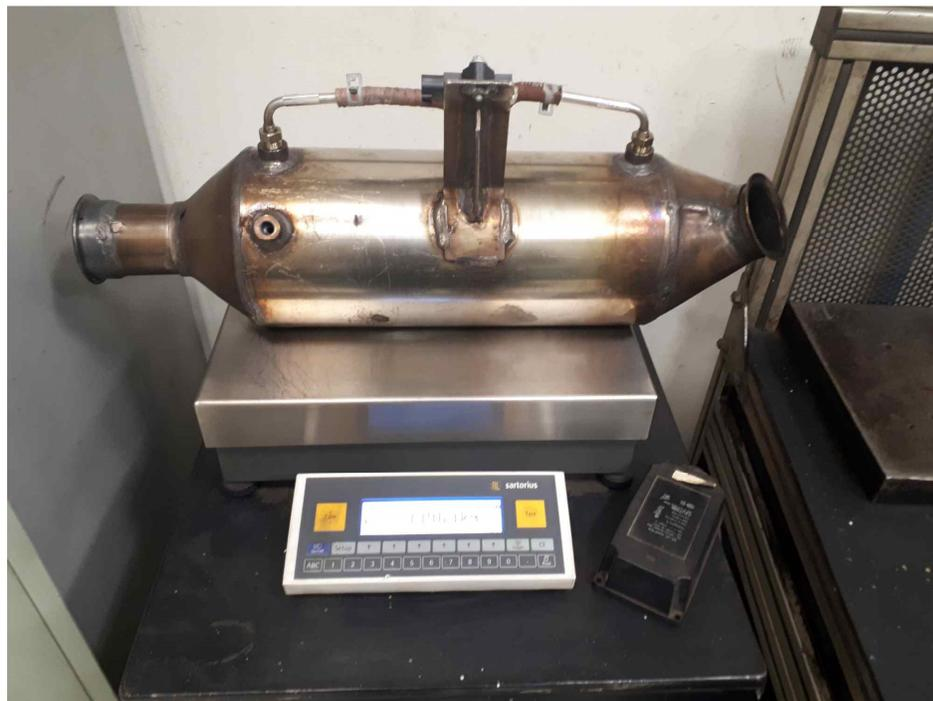
*Figura 16 – Exemplo de medição de massa do filtro DPF*
