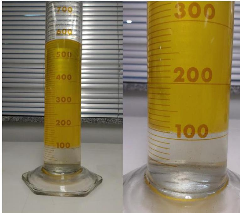
Figura 1: Mistura de diesel+ água retirados do filtro após o teste.
