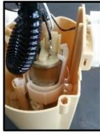
Figura 3: Aspecto do copo da bomba de combustível elétrica "in tank" após o teste de armazenamento de combustível por 30 dias
