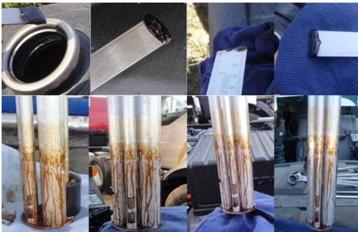
Figura 3 – Fotos de pescador e raspagem dos tanques abastecidos com B10, no pátio da empresa
