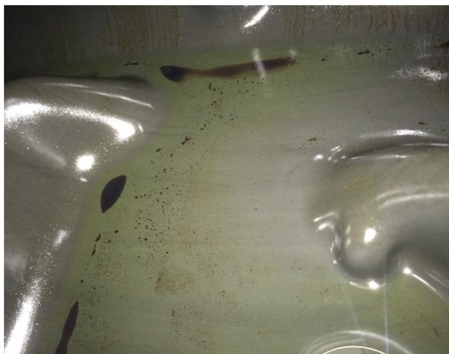
Figura 16 - Resíduo de biocombustível dentro do tanque
