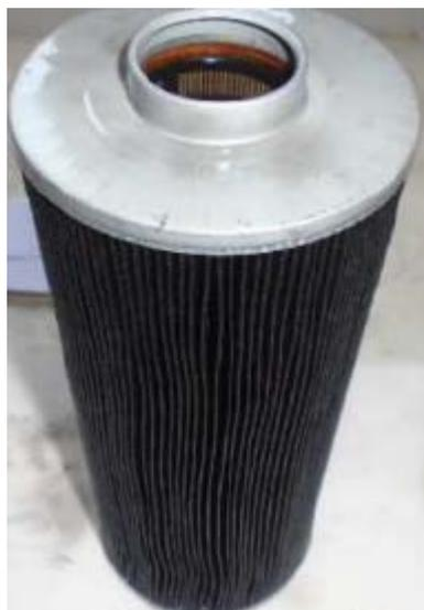
Figura 5 – Filtro entupido devido à biocamada envolvendo a mídia, veículo de cliente usando B10, com abastecimento em postos
