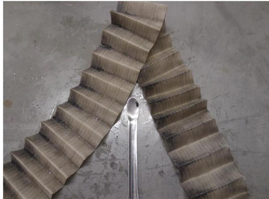
Figura 2: Media filtrante pré-filtro 39.128km
