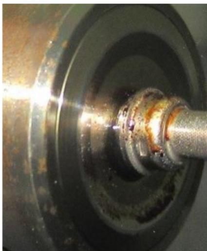
Figura 24 - Evidências de oxidação no common rail
