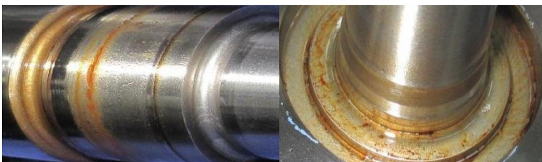
Figura 28 - Evidências de oxidação nos componentes internos da bomba de alta pressão
