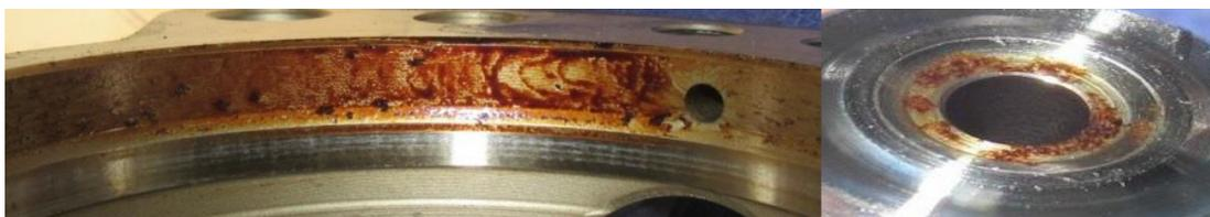
Figura 27 - Evidências de oxidação na bomba de alta pressão
