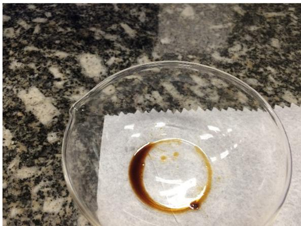
Figura 20 - Resíduo retirado da bomba de combustível
