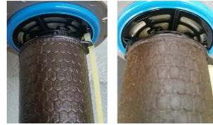
Figura 4: Aspecto do elemento filtrante do filtro de combustível antes e depois do teste de armazenamento de combustível por 30 dias
