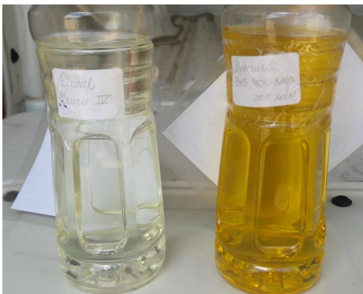
Figura 04: Amostras de diesel Euro IV e diesel S10 B15 70% soja / 30% sebo à temperatura ambiente
