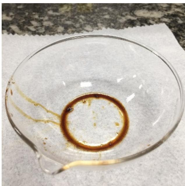
Figura 17 - Resíduo retirado do tanque de combustível
