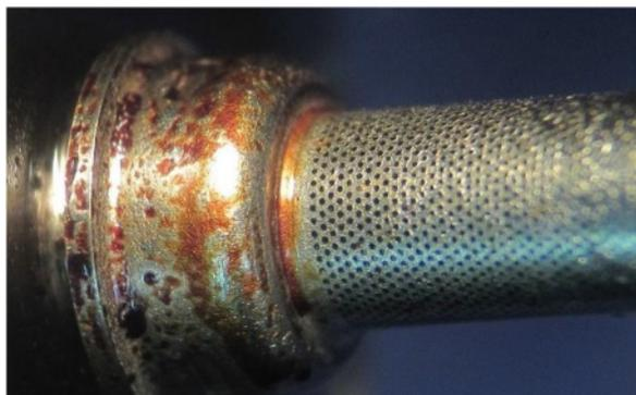
Figura 25 - Evidências de oxidação nos componentes internos do common rail
