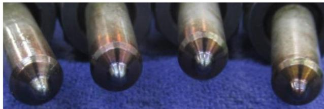
Figura 22 - Detalhe de contaminação do terceiro conjunto de injetores utilizado no teste
