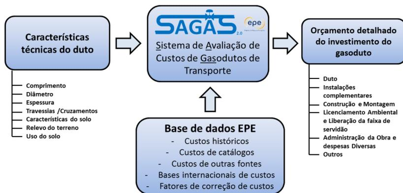
Figura 2. Esquema de funcionamento do SAGAS
