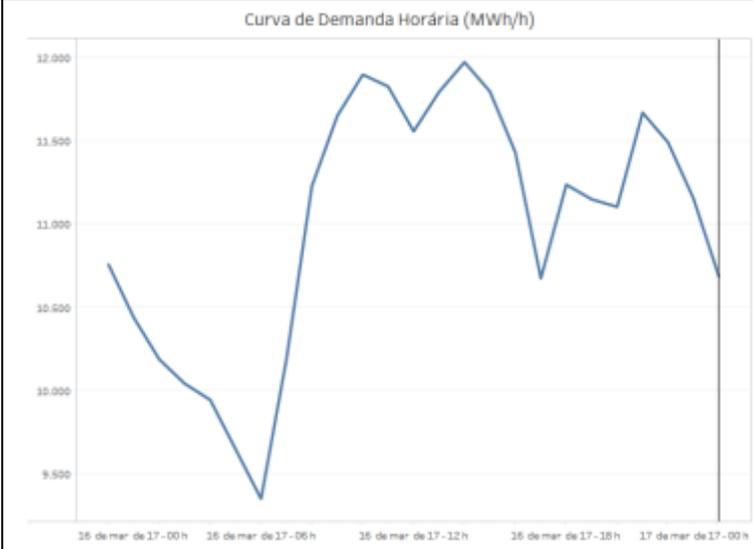
Gráfico 4 – Curva de carga verificada no dia 16/03/2017 no Subsistema Nordeste (MWh/h).
