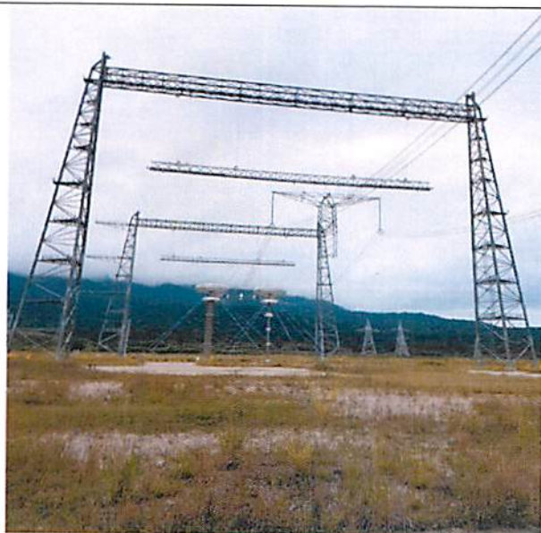
Toróides superior 1600 kV DC (ao fundo) e suportes de armazenamento
