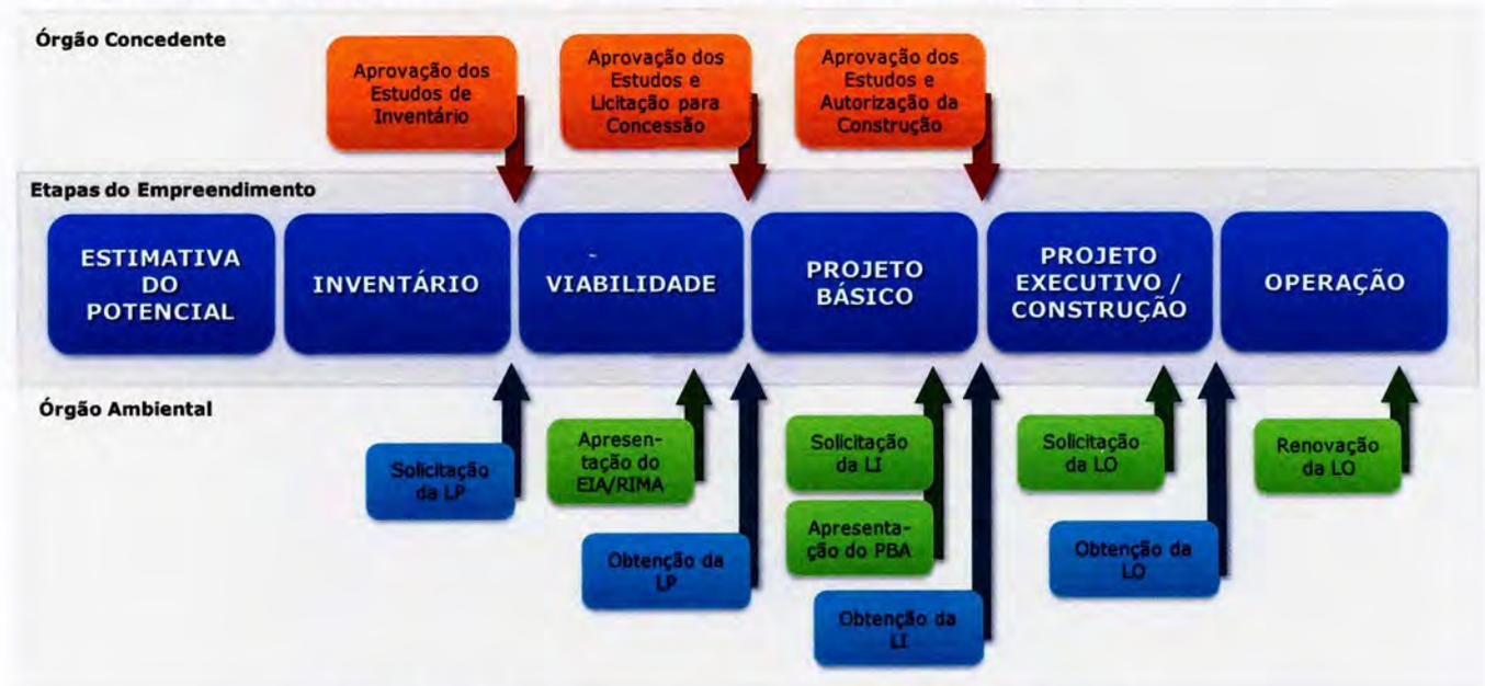
Figura 3.0.1: Processo para implantação de UHEs. (CEPEL, 2015)
