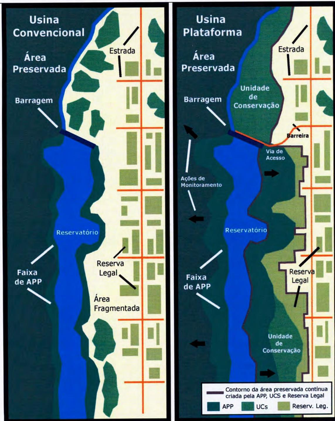
Figura 3.3.1: Ilustração esquemática da diferenciação de uma usina-plataforma.
