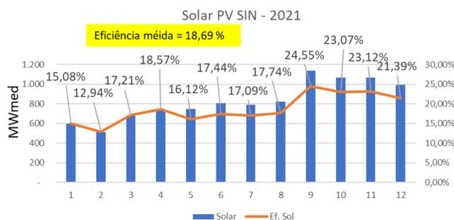
**Figura 10:** Eficiência Solar PV SIN – 2021 de Jan (1) a Dez (12) **Fonte:** ONS, compilado por COELHO, MAA.
