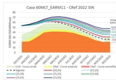
Figura 184 - Comparação da trajetória da energia armazenada simulada para o caso 60MLT\_EARM11 com as curvas da CRef.
